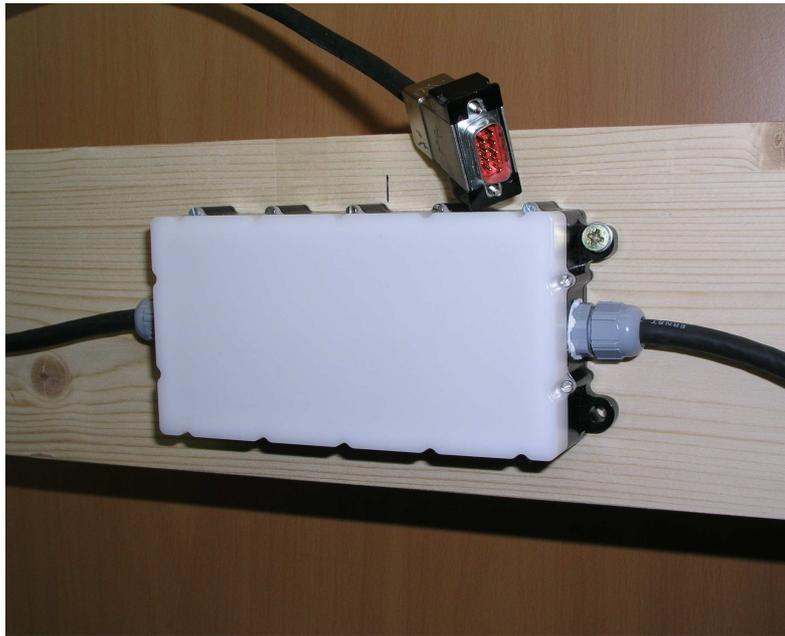
Abbildung 2.9.: Medium Range Radar Sensor
