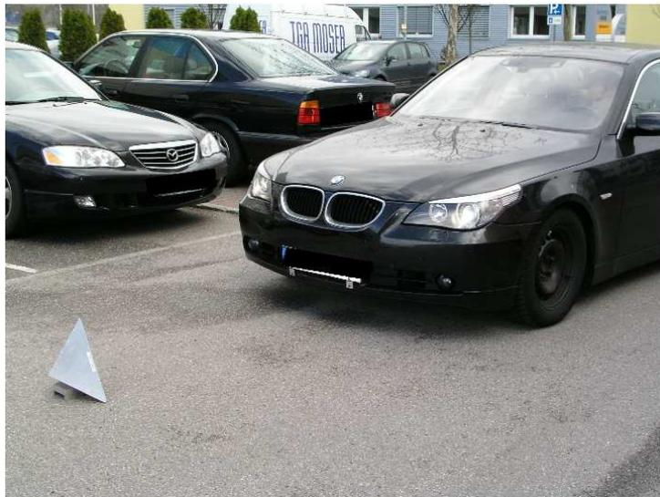
Abbildung 1.1.: Testfahrzeug und Cornerspiegel(Radarreflektor)
